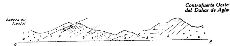
Fig. 2.—Serie entre Dahar de Agla e Izerafen. 1, dolomia; 2, bancos potentes calizos; 3, calizas alveolares infraliásicas; 4, calizas; 5, pudingas lutecienses; 6, areniscas y margas con pequeños lentejones calizos (Flysch); 7, dolomia; 8, bancos calizos; 9, Flysch; 10, dolomia del Tidufal.
