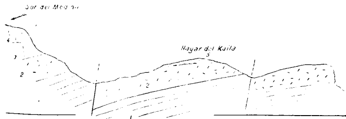
Fig. 9.—Corte longitudinal de la cima de Sor del Medina. 1, bancos calizos; 2, calizas en masa; 3, bancos calizos estrechos; 4, calizas en masa; 5, Flysch.
